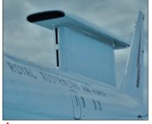
🛕 Fig. 6 Northrop-Grumman MESA radar.
